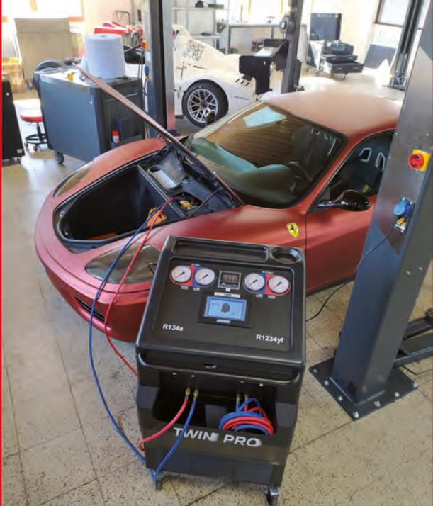
Klimaanlagen Service für die R134a und R1234yf Kältemittel
