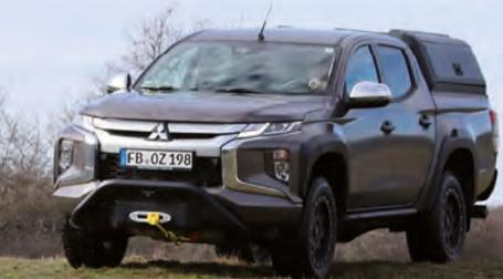
Unter der Haube arbeitet ein der aktuellen Abgasnorm Euro 6d Temp EVAP entsprechender 2.268 cm<sup>3</sup> und 110 kW/150 PS starker ClearTec-Turbodiesel, der bereits ab 1.750 U/min sein volles Drehmoment von 400 Nm anbietet. Seine Höchstgeschwindigkeit von 174 km/h und eine Beschleunigung von 12,4 Sekunden auf 100 Sachen sind eher Nebensache, viel wichtiger erscheint der moderate Verbrauch von durchschnittlich 7,5 Liter Diesel bei einer CO<sub>2</sub>-Emission von 206 - 198 g/km.
