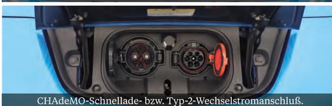
CHAdeMO-Schnelllade- bzw. Typ-2-Wechselstromanschluss.
